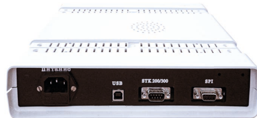
Задняя панель дефектоскопа.
