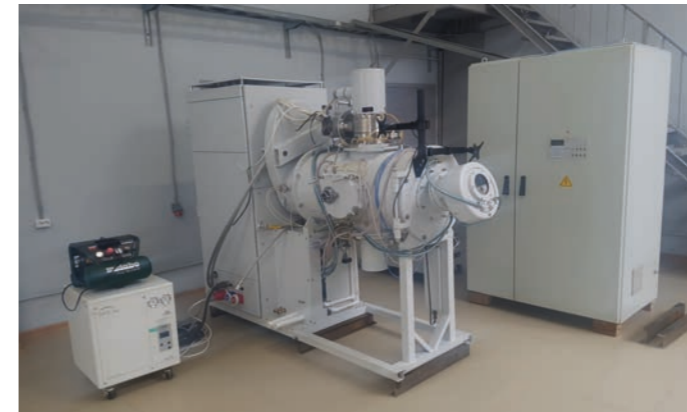
Установка для испытаний электронно-лучевых пушек и отработки технологии электронно-лучевого переплава
