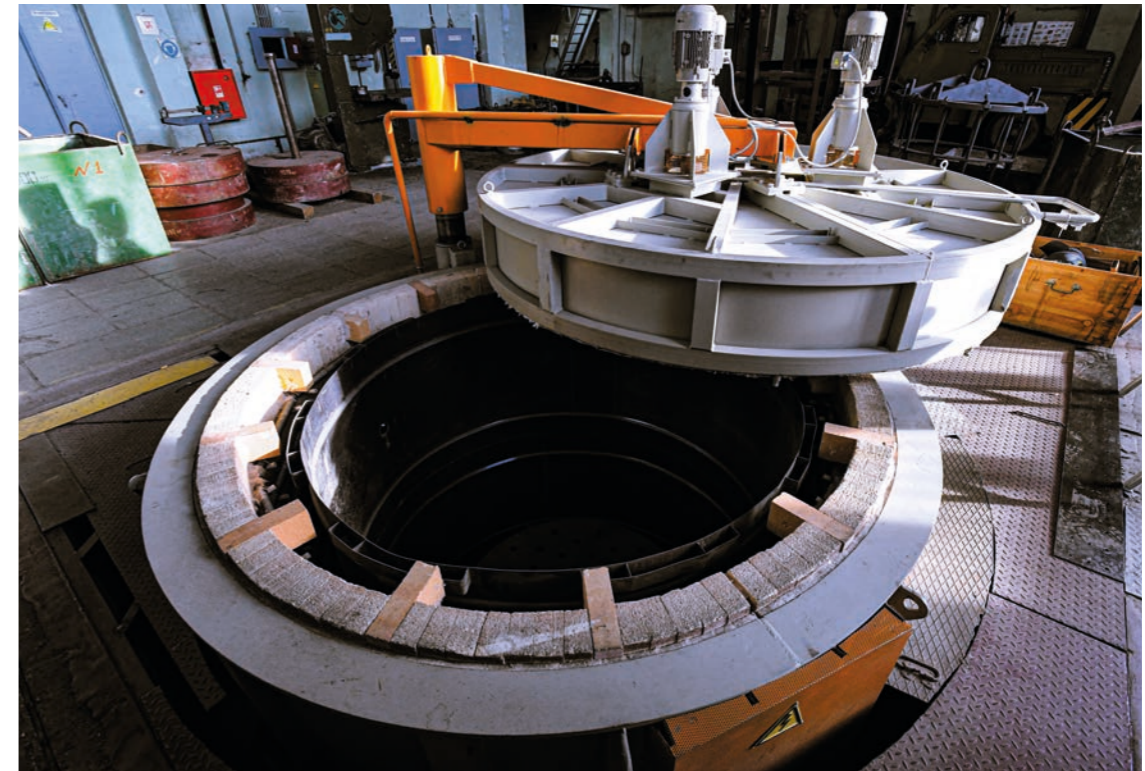
Шахтная печь для термической обработки деталей с размерами L \approx 3000 мм, диаметром \approx 2000 мм.
