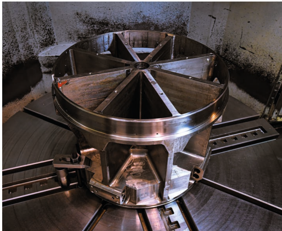
Катушка из титанового сплава для испытательного стенда.
