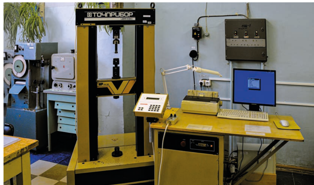
Разрывная испытательная машина для проверки механических свойств материалов.
